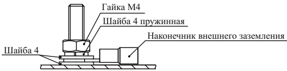
Рисунок 3 – Установка элемента заземления
